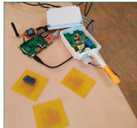
de sensores. El conjunto de estas “motas” constituye la red inalámbrica de sensores o redes WSN (*Wireless Sensor Network*). Para poder comprobar la eficacia de la red inalámbrica será necesario probar las mediciones realizadas en edificios ya monitorizados con sistema de cableado para poder comparar resultados.■
