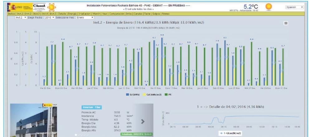
Figura 9. Visualización de la producción eléctrica, la irradiación y los parámetros de mérito diarios "Final Yield" (kWh/kWp), y "Performance Ratio" PR.
